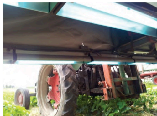
Figuur 5: UV behandeling tegen schimmel Bron: CLM
