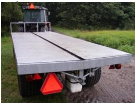
Transportwagen met afschot naar een opvanggoot. Foto: PPO
