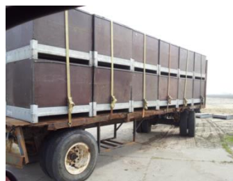
Transportwagen met lekbakken, waarop de kisten staan. Foto: André Conijn, Albert Groot BV
