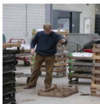
Fig. 1. Voorbeeld van een stresstoets: de valtoets
